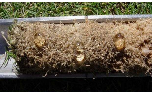
Abb.2: Beurteilung der Hydrophobie einer RTS mit aufgetragenen Wassertropfen auf einen ausgetrockneten Bodenkern beim „Water Droplet Penetration Test“ (LEINAUER et al.,2007).
