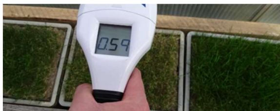
Abb.1: Prüfung des NDVI-Wertes mit GreenSeeker. (Foto: K.G. Müller-Beck)
